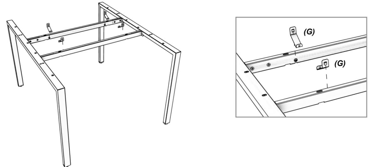
3. - Encaixe a Calha Central(3), na Alça calha(G).
