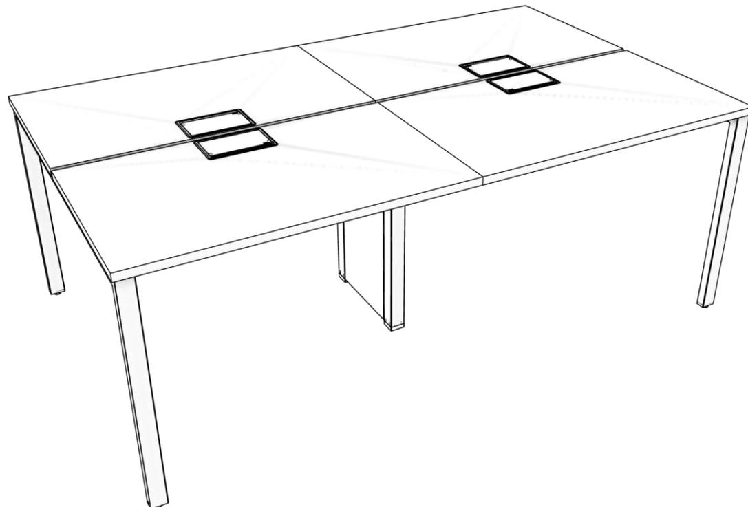
Faça a união dos tampos fixando as chapas de união presentes no kit do módulo auxiliar.
